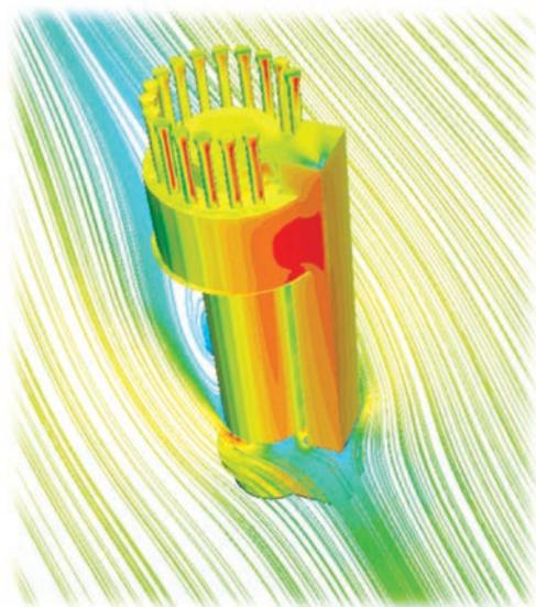
Рис. 4. Численное моделирование ветрового воздействия в программном комплексе ANSYS
