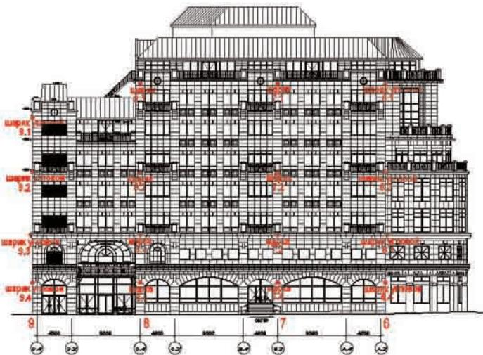
Рис.4. Схема расположения деформационных марок на восточном фасаде здания
